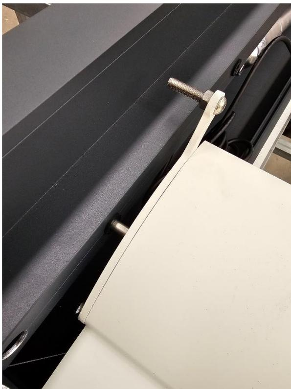
16. Une fois l'axe fixe posé, un ressort et un axe avec une butée doivent être insérés de l'autre côté. A l'aide d'un outil, poussez l'axe dans la lame et placez celle-ci dans le trou opposé. Lorsque vous lâchez l'axe, le ressort fait entrer la goupille dans le trou de la poutre et de cette façon la lame est en place, vous pouvez passer aux suivantes.
