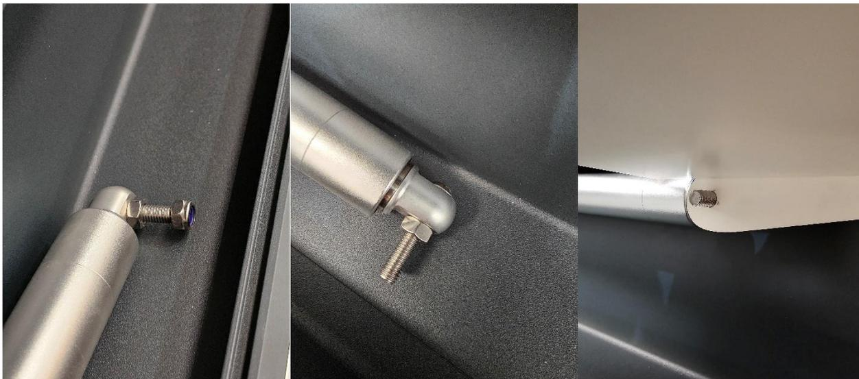
L'écrou autobloquant doit être mise en place et ne pas être trop serré. Juste assez pour bloquer la sortie de la visse. Le moteur doit pouvoir tourner pendant le fonctionnement, ce qui n'est pas le cas s'il est serré au maximum.
