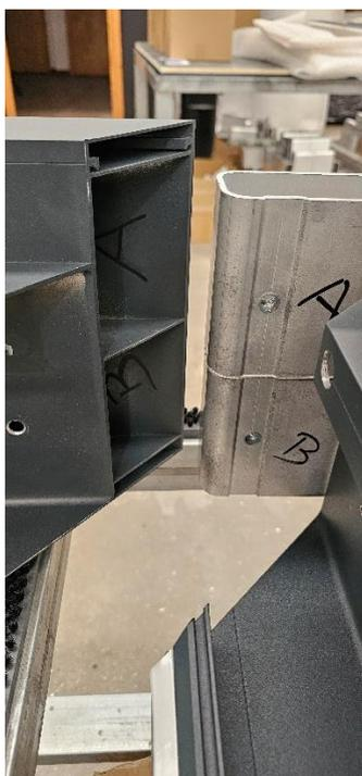
3. Avant de monter la poutre, les équerres d'alignement doivent être insérés dans le cheneau (à côté du bandeau LED). Les placer sur la poutre avec l'équerre, puis glisser les équerres et l'équerre d'alignement.
